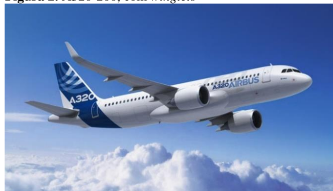
Figura 2. A320-200, com winglets
